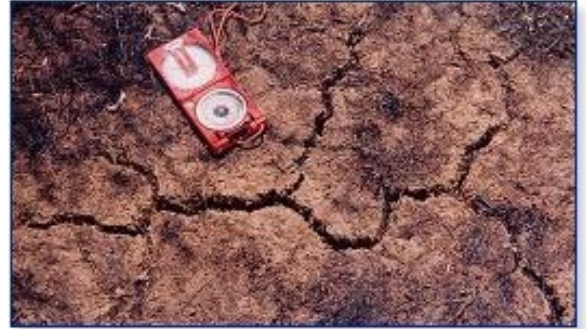
Phénomène de retrait des argiles par dessiccation (source BRGM)
